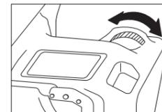
\* Bei manchen Canon Kameras, wird, wenn Sie das Kameramodus Auswahrad auf ‚Av‘ stellen und die Helligkeit einstellen, indem Sie den Blendenring am Objektiv drehen, die Belichtungszeit automatisch angepasst. In diesem Fall müssen Sie die Belichtungszeit nicht anpassen, was im M Modus nötig ist.
