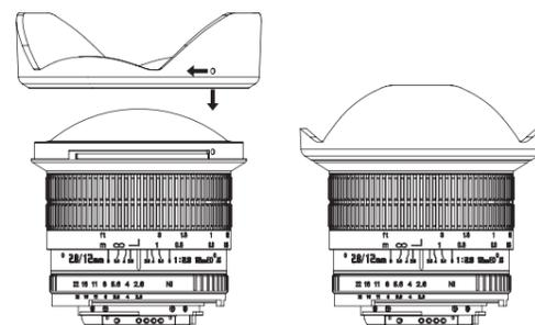
Richten Sie den Referenzpunkt auf der Gegenlichtblende am Referenzpunkt des Objektivs für die Gegenlichtblende aus, schieben Sie die Gegenlichtblende auf das Objektiv und drehen Sie sie im Uhrzeigersinn, bis Sie ein Klickgeräusch hören.
